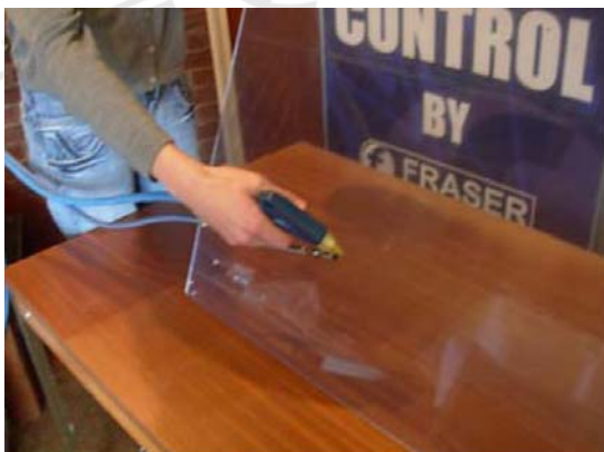
承印物倾斜以避免工作台与承印物之间耦合静电
