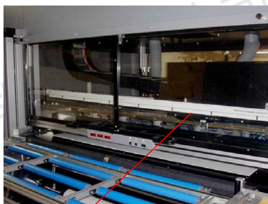
在薄膜从Durst印刷机的纸张上撕下后用离子风暴中和静电。
