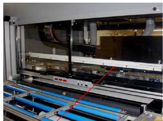
在薄膜从Durst印刷机的纸张上撕下后用离子风暴中和静电。
